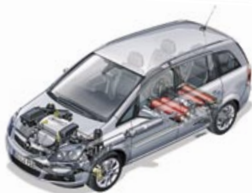
Le gaz est stocké dans des bombonnes cylindriques qui sont intégrées dans le plancher des voitures.
